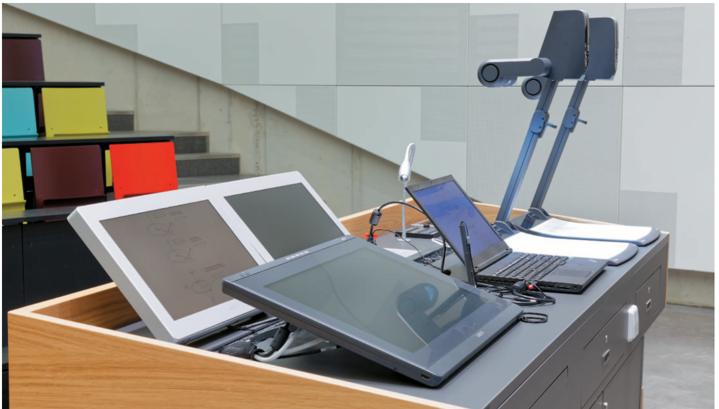
Dozentenpult mit zwei Novis-Mitschaumonitoren, Wacom Pen-Displays und WolfVision Visualizern
