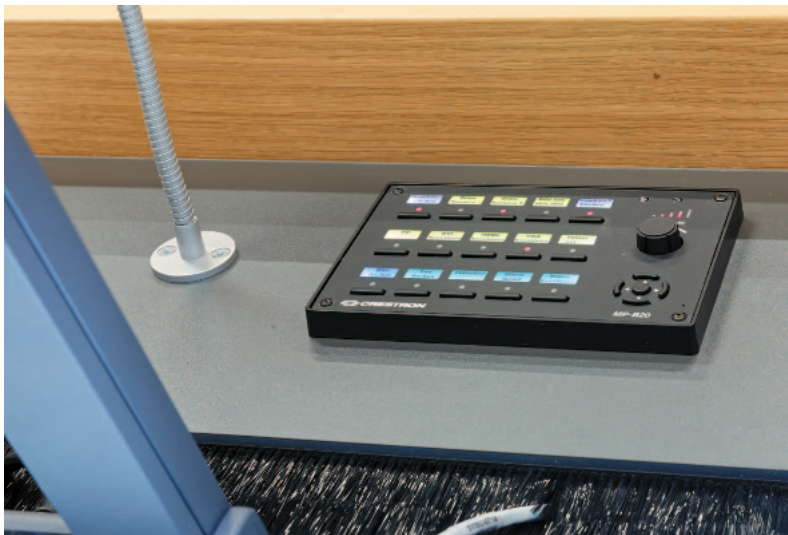
Crestron MP-B20 an einem Dozentenpult
